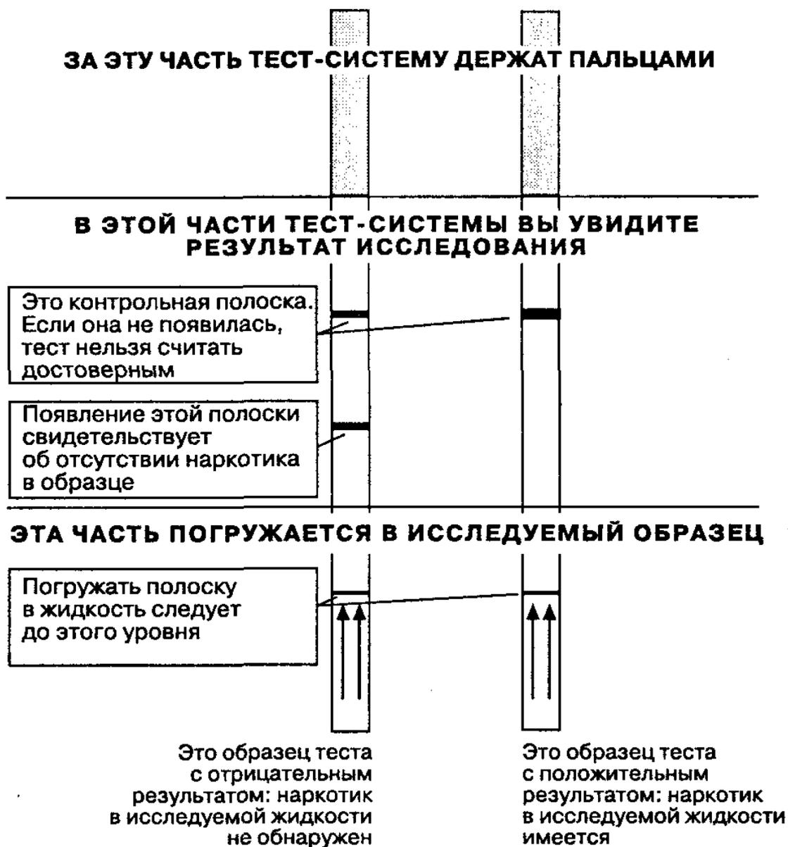
**Рис. 1.** Система для экспресс-теста на содержание наркотиков
