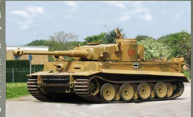
Танк «Тигр». Лобовая броня 120 мм. Пушка 88 мм Лучшая танковая пушка 2-й Мировой войны.
